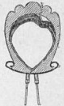
Прокладка внутри шины, не допускающая к камере острые предметы
