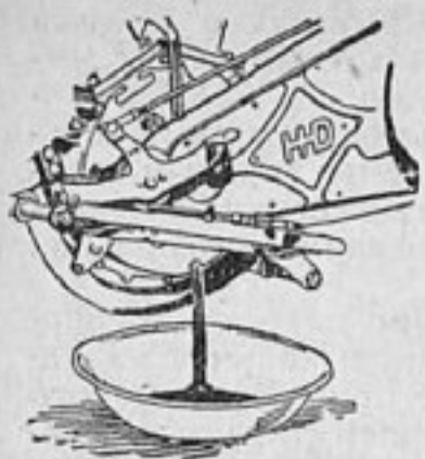
Рис. 2. Спуск излишнего масла
