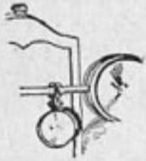
Косо направо поставленный фонарик, помещаемый между главными фонарями, освещает правую часть дороги
